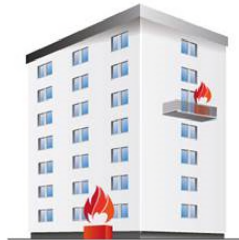
Brand außerhalb eines Gebäudes „Sockelbrand“
